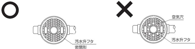
(2) 洗濯機用排水口のようにトラップがない場合は、トラップ升を設置してください。トラップ機構がないと、臭気が升を通して室内に侵入するおそれがあります。
