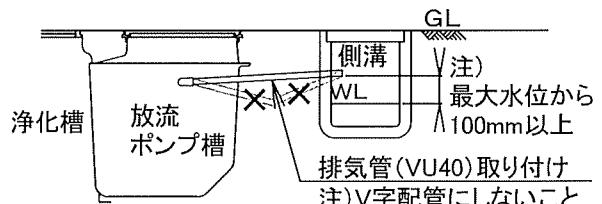
**△ 注意** …これらの注意を怠ると、雨水や側溝の水が排気管を逆流し、浄化槽水位が異常に上昇するおそれがあります。また、空気の逃げ道が無くなることで浄化槽から臭気が発生したり、消毒剤から発生する塩素ガスによって浄化槽内の機器類、建物内の台所及びドア取手などの金属類が腐食する恐れがあります。
