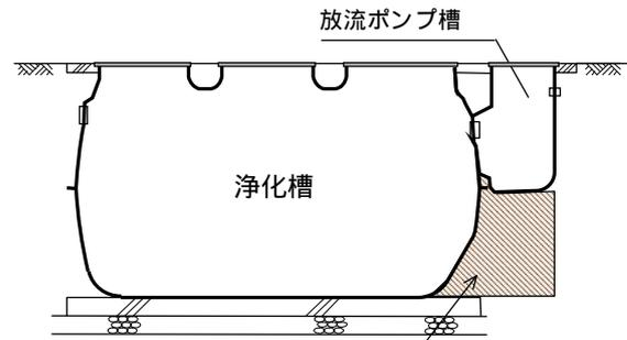
埋戻しの際、放流ポンプ槽の底部及び浄化槽とポンプのすき間には十分土を入れてください。
