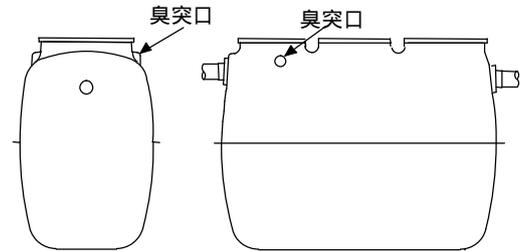
浄化槽の内と外から、DV65 ソケット 2 個とパイプ (目安長さ 70mm) で臭突口を挟み込みます。ソケットとパイプは接着剤でしっかりと接続してください。
