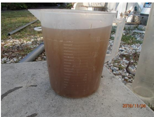
図8 吸引した底部汚泥の状況
