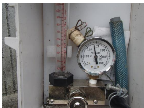
図 13 吸引前の有負荷風量及び圧力 220ℓ/分 (27Kpa)
