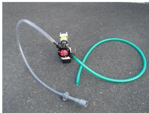
図4 ドリルポンプと各機材の接続状況
