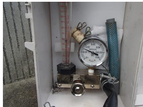
図 14 吸引後の有負荷風量及び圧力 600ℓ/分 (15Kpa)
