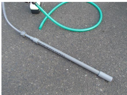
図3 吸入側の延長状況
